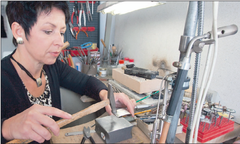
Die Goldschmiedin in ihrer Plochinger Werkstatt. Zu ihren Werkzeugen gehört auch ein Mundlötrohr, bei dem sie die Luftzufuhr über ein Mundstück regelt.
